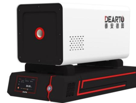
短型热电偶检定炉
